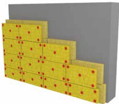
Рис.5. Схема фиксации теплоизоляции со смещением
